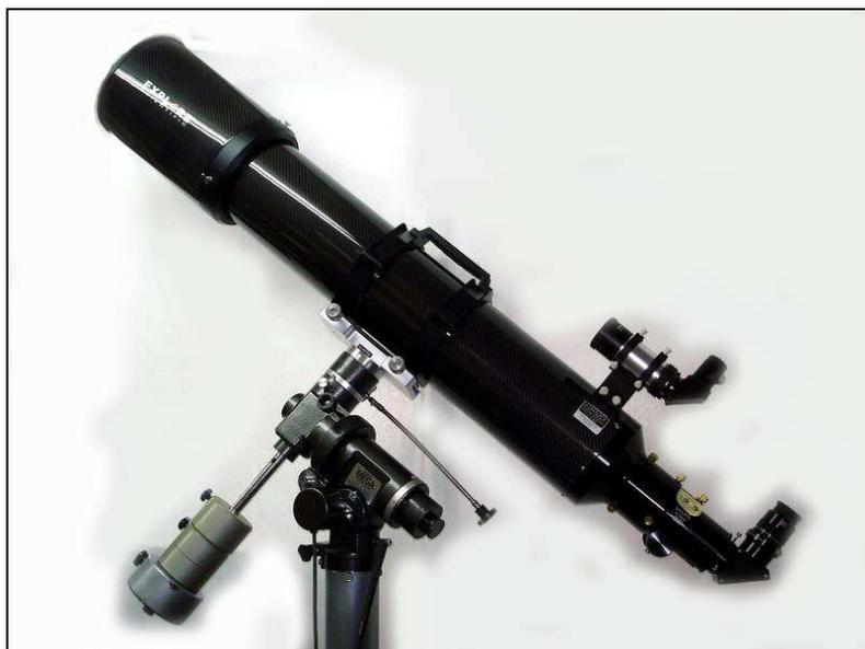
鏡筒、フードはカーボンファイバーを採用し、重量軽減と温度膨張を抑えています。フードは着脱式で、対物セルに 3 点のねじで固定します。対物レンズ前蓋をはずすとクリアーなコーティングを施したレンズと、筒内の遮光リングが見えます。遮光リングは筒内に 3 枚配置されており、コントラストの向上効果を狙っています。
