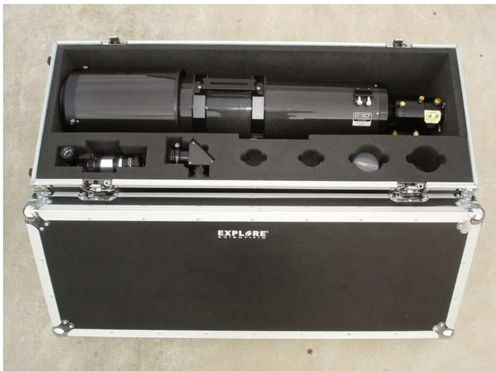
望遠鏡本体 12kg とケース重量 27.5kg、プリズムやアイピース類を加えると 40kg 以上となり軽量化するべきですが、輸送や移動時の安全性を優先してこれだけのしっかりとした安全なケースを標準付属にしているメーカーの姿勢が評価できます。
